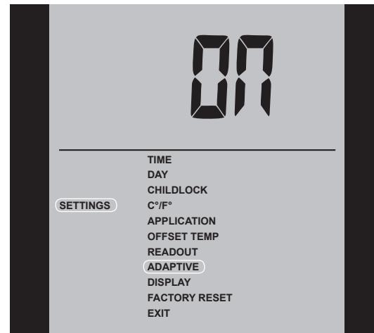
La fonction d'adaptation calcule le moment où le thermostat doit démarer le système de chauffage pour assurer que la température requise est atteinte à l'heure réglée. Trois jours après l'activation de la fonction d'adaptation, cette dernière a appris quand le chauffage doit être démarré pour obtenir la bonne température.
