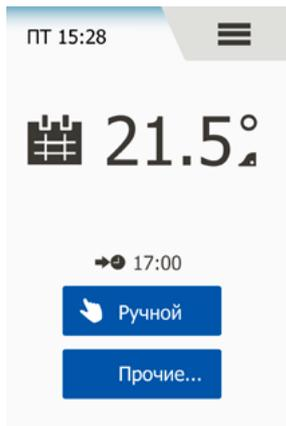
Термостат позволяет автоматически регулировать температуру в соответствии с недельным графиком по Вашему выбору. Термостат поставляется с предварительно установленными программами для простого и экономичного управления обогревом, что подходит для большинства пользователей, см. раздел Заводские установки: График обогрева.
