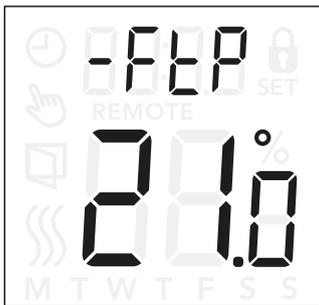
Consoante o tipo de sensor e a definição da aplicação do sensor, a temperatura do sensor de piso (-FEP) e do sensor de divisão interno (-rEP) pode ser monitorizada aqui.
