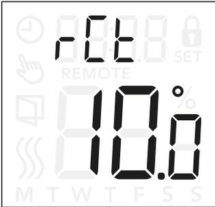
Esta definição permite-lhe definir o ponto de regulação da temperatura do termóstato quando este é controlado remotamente.
