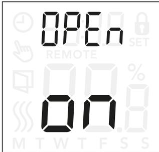
Esta definição permite-lhe ativar a função Janela aberta. O termóstato pode detetar uma janela aberta ao registar uma diminuição rápida na temperatura.
