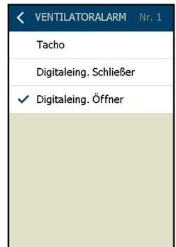
Der Ventilatoralarm kann auch über einen Alarmrelaisausgang am Motor/Umrichter erfolgen. Das Alarmrelais am Motor/Umrichter mit einem Digitaleingang am AHC-3000-Regler verbinden.
